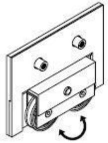
Roldanas com sistema compensador de desníveis no piso
